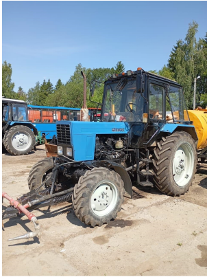
КМ -82БГ машина коммунально-уборочная на базе трактора МТЗ-82.1
