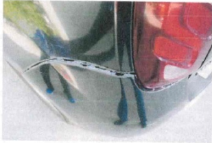
Фото 3. Вид 1 поврежденный корпуса
