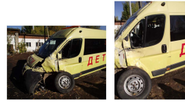
Фото 15, 16. Деформированы передняя стойка левая боковины кузова, шланг, усиитель, левая боковина кузова с обратным склосом, дверь, левая, диван, лобового стекла. Уничтожена фара левая, крыло левого и заднего и заднего левое, крыло переднее левое, защита крыла переднего левого.
