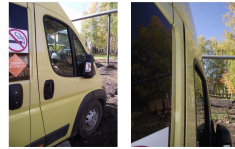
Фото 13, 14. Деформирован проем двери передней правой, верхняя часть, проема сместилась внутрь кузова, между верхней частью двери и проемом образовался люфт.
