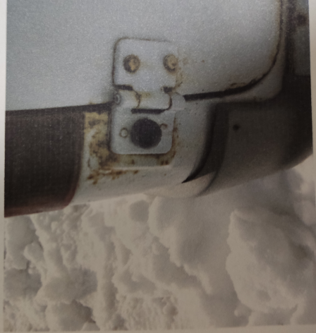
ей задка по месту сопряжения и в нижней части ы сквозной коррозией.
