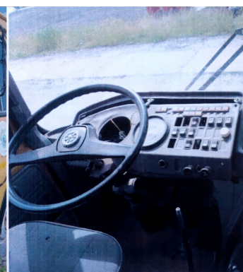
Фото 3. повреждена панель приборов.
