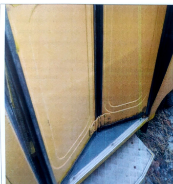
Фото 4 . состояние кузова.сквозные дыры ,коррозия дверей
