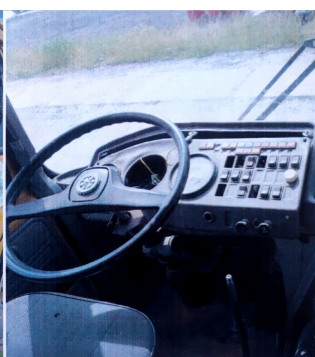
Фото 3. повреждена панель приборов.
