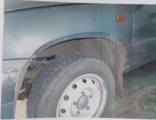
Фото 9. Состояние подкрылков (передние), коррозия
