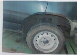
Фото 10. Состояние подкрылков (задние), коррозия
