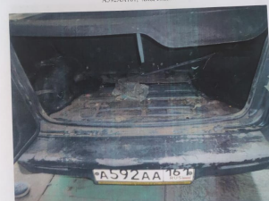
Фото 3 Состояние багажного отделения. Коррозия.
