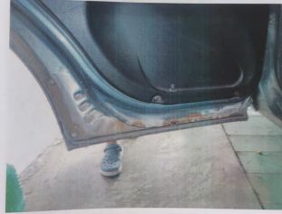
Фото 11. Состояние дверей, коррозия
