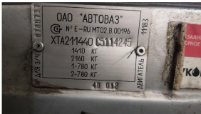
Фотография №7 – автомобиль легковой LADA-211440, LADA SAMARA Идентификационный номер VIN (капот)
