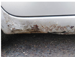
Фотография №10 – автомобиль легковой FORD FORD «ФОРДС» Повреждение порога
