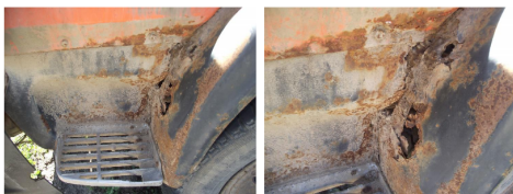
Фото 9, 10: Панель передней части крыла левого разрушена коррозией. Щиток подножки в задней части разрушен коррозией.
