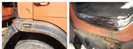
Фото 7: Панель передней части крыла правого разрушена коррозией.
