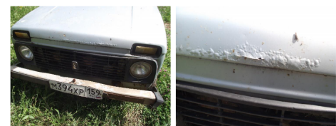
Фото 7, 8: Панель капота наружная в передней части поражена сквозной коррозией. Отслоение лакокрасочного покрытия.
