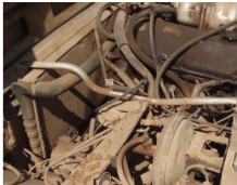
Фото 31: Радиатор системы охлаждения двигателя забит грязью. Двигатель автомобиля из-за износа негерметичен, подтекание масла.
