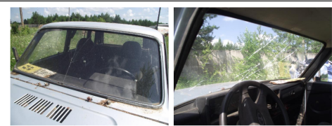
Фото 5, 6: Стекло ветрового окна сломано, многочисленные трещины, в том числе и в зоне работы стеклоочистителя со стороны водителя. Рычаги и щетки стеклоочистителя отсутствуют.
