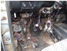
Фото 27: Электрооборудование в пассажирском салоне разрушено.
