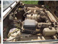
Фото 29, 30: Комплектация двигателя автомобиля, аккумуляторная батарея и колесо запасное отсутствуют. Двигатель автомобиля из-за износа негерметичен, подтекание масла. Радиатор системы охлаждения двигателя забит грязью.
