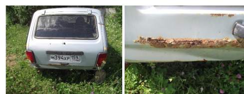
Фото 15, 16: Панель наружная двери задка в нижней части разрушена коррозией.
