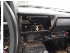
Фото 27: Электрооборудование в пассажирском салоне разрушено.
