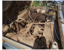
Фото 29, 30: Комплектация двигателя автомобиля, аккумуляторная батарея и колесо запасное отсутствуют. Двигатель автомобиля из-за износа негерметичен, подтекание масла. Радиатор системы охлаждения двигателя забит грязью.
