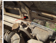
Фото 31: Радиатор системы охлаждения двигателя забит грязью. Двигатель автомобиля из-за износа негерметичен, подтекание масла.
