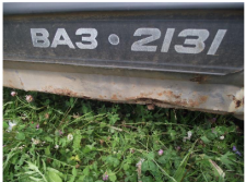
Фото 19, 20: Порог левой боковины кузова поражен коррозией до образования отверстий, деформирован.
