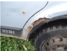
Фото 18: Панель боковины левая (крыло заднее левое в передней части) разрушена коррозией.
