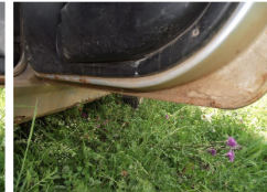
Фото 23, 24: Панели внутренние дверей правых в нижней части поражены коррозией до образования отверстий.
