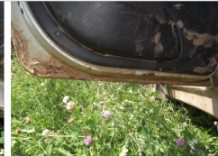
Фото 21, 22: Панели внутренние дверей левых в нижней части разрушены коррозией.
