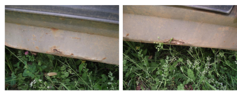
Фото 11, 12: Порог правой боковины кузова поражен коррозией до образования отверстий и трещин.
