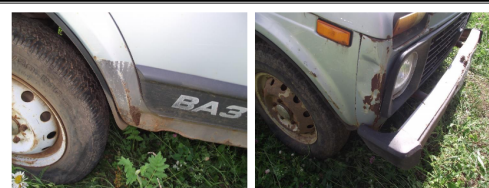
Фото 13: Панель боковины правая (крыло заднее правое в передней части) поражена сквозной коррозией.
