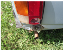
Фото 17: Панель боковины левая (крыло заднее левое в задней части) и панель наружная задка в нижней левой части деформированы. Рассеиватель фонаря заднего левого сломан.
