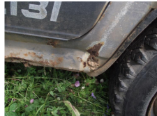
Фото 19, 20: Порог левой боковины кузова поражен коррозией до образования отверстий, деформирован.
