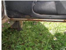
Фото 23, 24: Панели внутренние дверей правых в нижней части поражены коррозией до образования отверстий.
