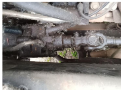
Фото 7: Гидроцилиндр негерметичен, подтекание масла.
