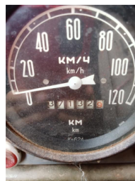
Фото 9: Показания счетчика пройденного пути одометра – 37 132 км., не соответствуют сроку службы и техническому состоянию автомобиля.
