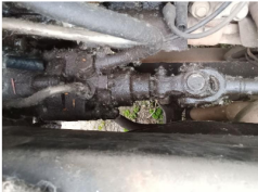
Фото 7: Гидроусилитель, негерметичен, подтекание масла.
