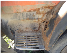
Фото 9, 10: Панель передней части крыла левого разрушена коррозией. Щиток подножки в задней части разрушен коррозией.
