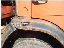
Фото 7: Панель передней части крыла правого разрушена коррозией.
