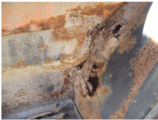
Фото 9, 10: Панель передней части крыла левого разрушена коррозией. Щиток подножки в задней части разрушен коррозией.
