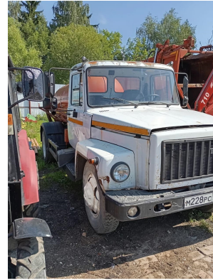
КО-503В-2 вакуумная машина на шасси ГАЗ-3309
