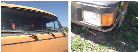
Фото 5: Стекло ветрового окна сломано, многочисленные трещины, в том числе и в зоне работы стеклоочистителя со стороны водителя.
