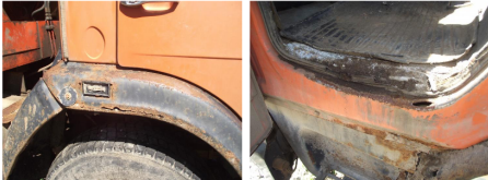
Фото 7: Панель передней части крыла правого разрушена коррозией.
