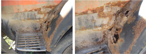
Фото 9, 10: Панель передней части крыла левого разрушена коррозией. Щиток подвозки в задней части разрушен коррозией.
