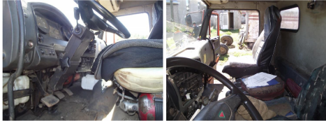
Фото 11, 12: Кабина автомобиля. Обивка сиденья водителя порвана.
