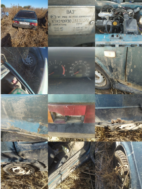
-Автомобиль марки BA321093, гос.рег.знак 608090 154, VIN XTA21093213974160, в технически-ремонтированном состоянии, синего цвета, кузов из металла, во всем кузове имеются, краски, следы коррозии.
