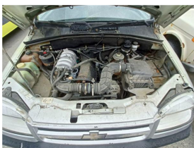
ДВС – следы подтекания рабочих жидкостей
