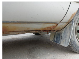
Крыло пер. прав – поверхностная коррозия в нижней части
