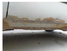
Дверь передняя правая-поверхностная коррозия в нижней части
