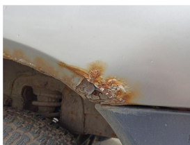
Боковина задняя левая-сквозная коррозия в задней части
