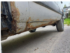
Крыло пер. лев – поверхностная коррозия в нижней части, дверь пер. лев – сквозная коррозия в нижней части, порог левый – сквозная коррозия в задней
