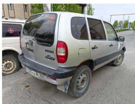
Боковина задняя правая-сквозная коррозия в нижней части
