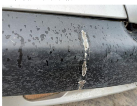
Бампер передний-трещина, задиры пластика слева
