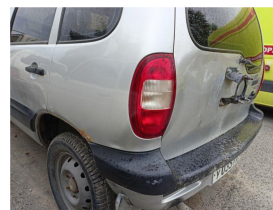
Боковина задняя левая-вмятина, сквозная коррозия в задней части
