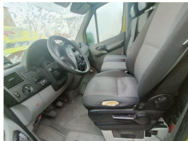
Кресло переднее левое – повреждение обшивки
