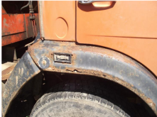
Фото 7: Панель передней части крыла правого разрушена коррозией.
