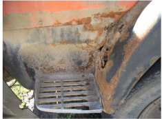
Фото 9, 10: Панель передней части крыла левого разрушена коррозией. Щиток подвояжки в задней части разрушен коррозией.
