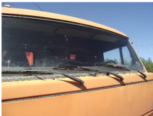
Фото 5: Стекло ветрового окна сломано, многочисленные трещины, в том числе и в зоне работы стеклоочистителя со стороны водителя.
