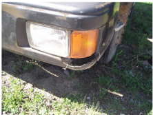
Фото 6: Бампер передний сломан в левой части с отсутствием фрагмента.
