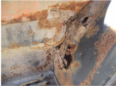
Фото 9, 10: Панель передней части крыла левого разрушена коррозией. Щиток подвояжки в задней части разрушен коррозией.
