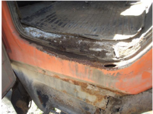
Фото 8: Основание кабины в левой части поражено сквозной коррозией.
