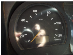
Фото 14: Спидометр электронный, показания счетчика пройденного пути одометра зафиксировать невозможно.
