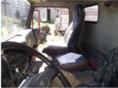
Фото 11, 12: Кабина автомобиля. Обивка сиденья водителя порвана.
