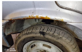
Фотография №12 – автомобиль легковой LADA 211440, LADA SAMARA (повреждение заднего правого крыла (коррозии))
