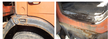
Фото 7: Панель передней части крыла правого разрушена коррозией.
