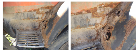
Фото 9, 10: Панель передней части крыла левого разрушена коррозией. Щиток подножки в задней части разрушен коррозией.
