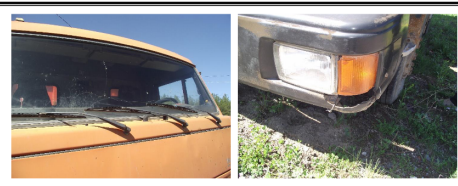
Фото 5: Стекло ветрового окна сломано, многочисленные трещины, в том числе и в зоне работы стеклоочистителя со стороны водителя.
