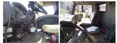
Фото 11, 12: Кабина автомобиля. Обивка сиденья водителя порвана.
