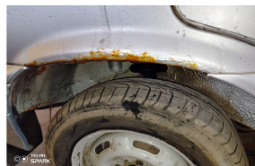
Фотография №12 – автомобиль легковой LADA 211440, LADA SAMARA (повреждение заднего правого крыла (коронина))
