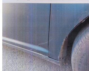
5. Состояние кузова. Коррозия.
