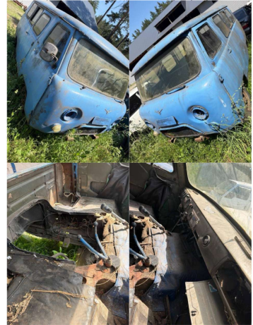
Транспортное средство УАЗ 3303, 1990 г.в., синего цвета, кузов № 33030040214391, в нерабочем состоянии, отсутствует двигатель, коробка разбита
